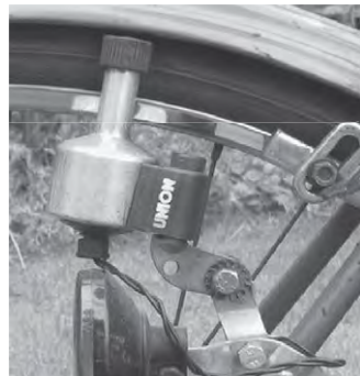
■ Gambar 7.8 Dinamo sepeda digunakan untuk menyalakan lampu.
